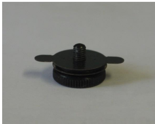
图片9：组装好的压力室，如果水平安装，起作用的是0.2毫米孔，如果垂直安装则是0.3毫米
