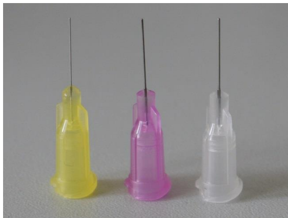
图20: 小, 中, 大三种规格的针 ((S 0.1 mm, M 0.15 mm, L 0.2 mm)
